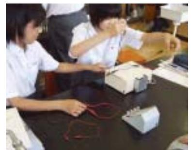
ワニ口クリップ付導線を十分に用意したことで、接続が容易になり、手際よく組替えながら回路に接続するとともに、電流計の目盛を読み記録していた。
