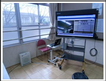
本校会議室の IWB 周辺の機器設置状況①。 TV 会議システムの音声は、外部スピーカーで 分教室の音声を出力し、ワイヤレス屋外アン プで本校の音声を入力した。
