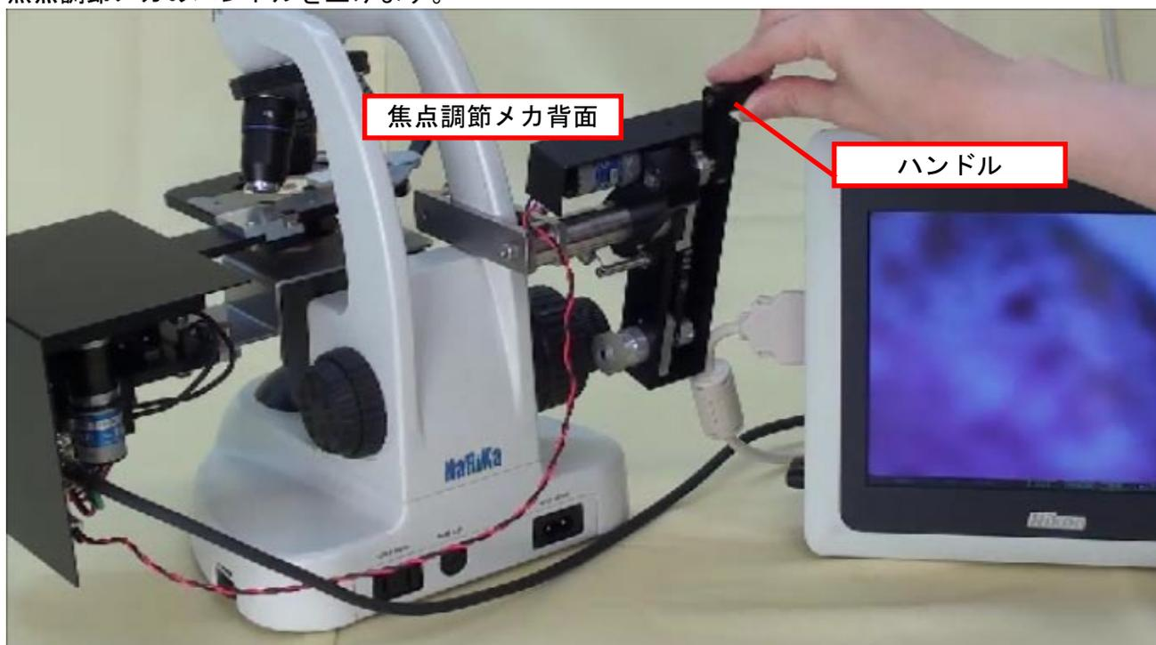
専用ディスプレイユニットを見ながら、生物顕微鏡本体の調節ハンドルを回してピントを合わせます。
