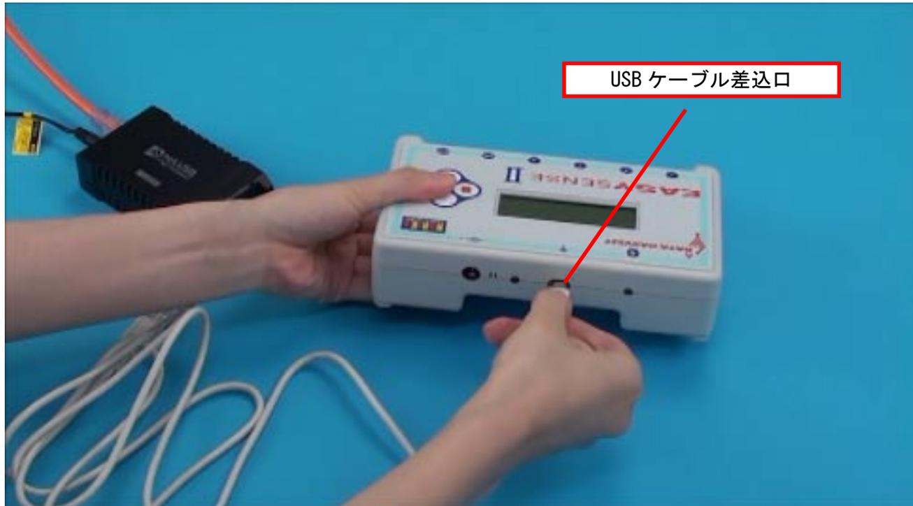
コンピュータ接続用ケーブルの反対側を USB デバイスサーバーに接続します。
