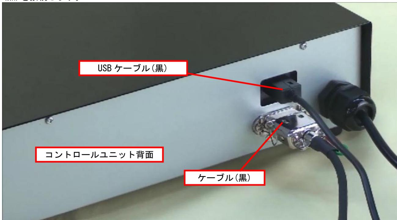
コントロールユニットの前面にコントローラーのケーブルを接続します。
