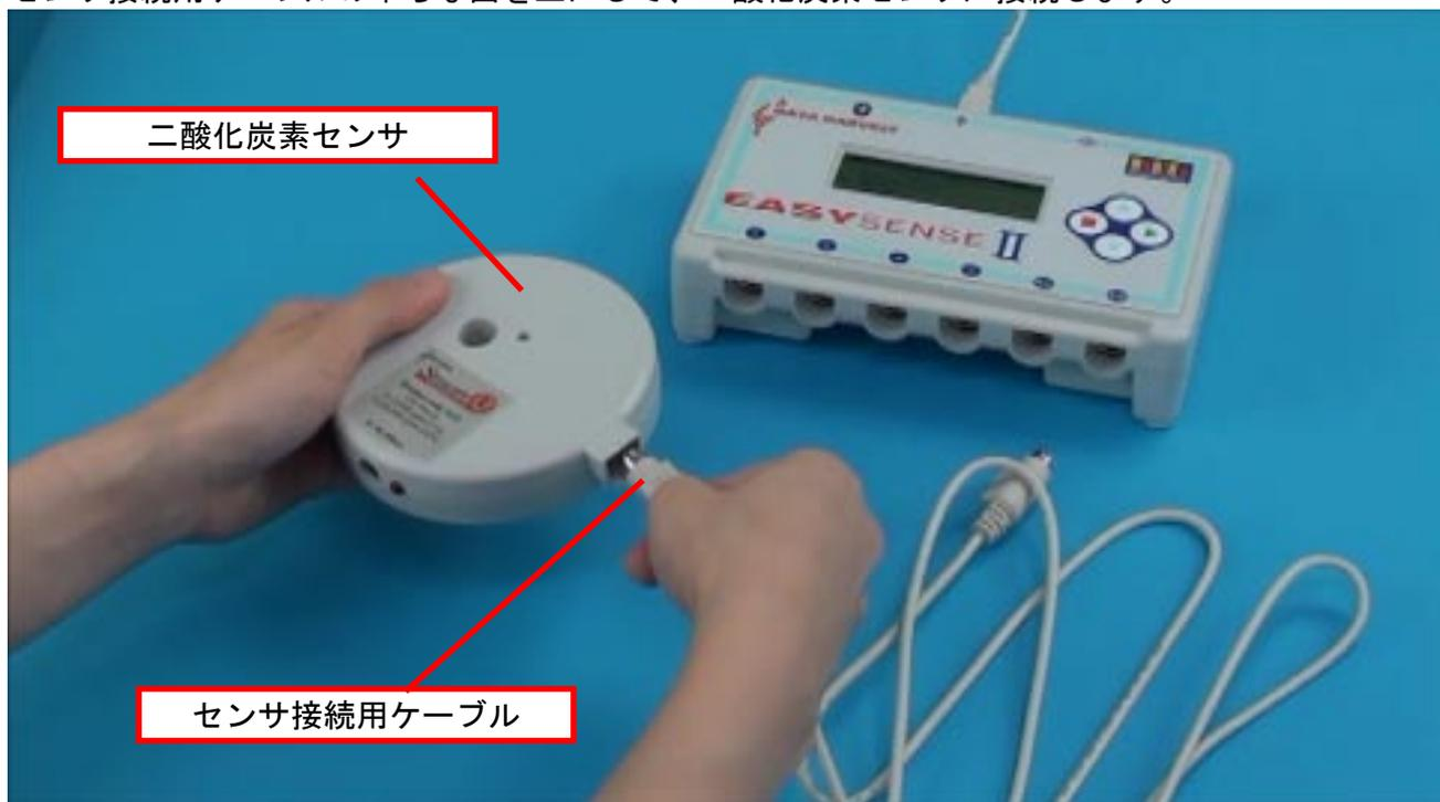
センサ接続用ケーブルの平らな面を上にして、イージーセンス本体前面に接続します。
