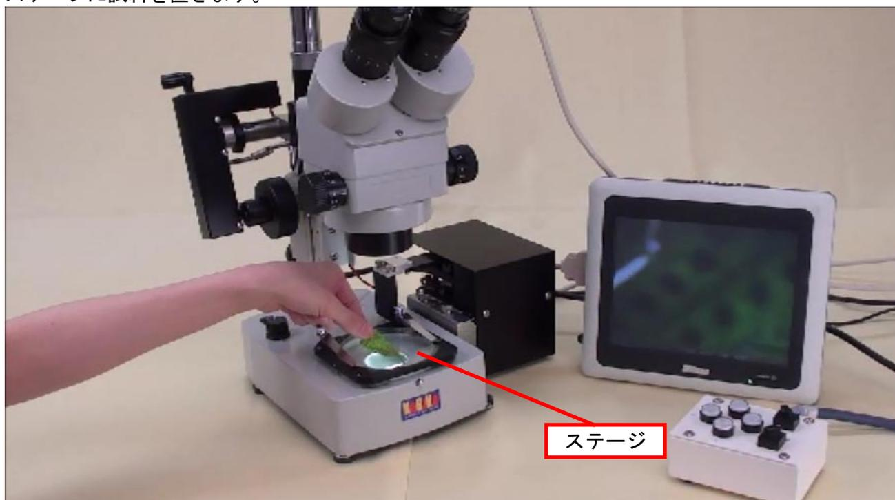
焦点調節ハンドルを回して、ピントを調節します。
