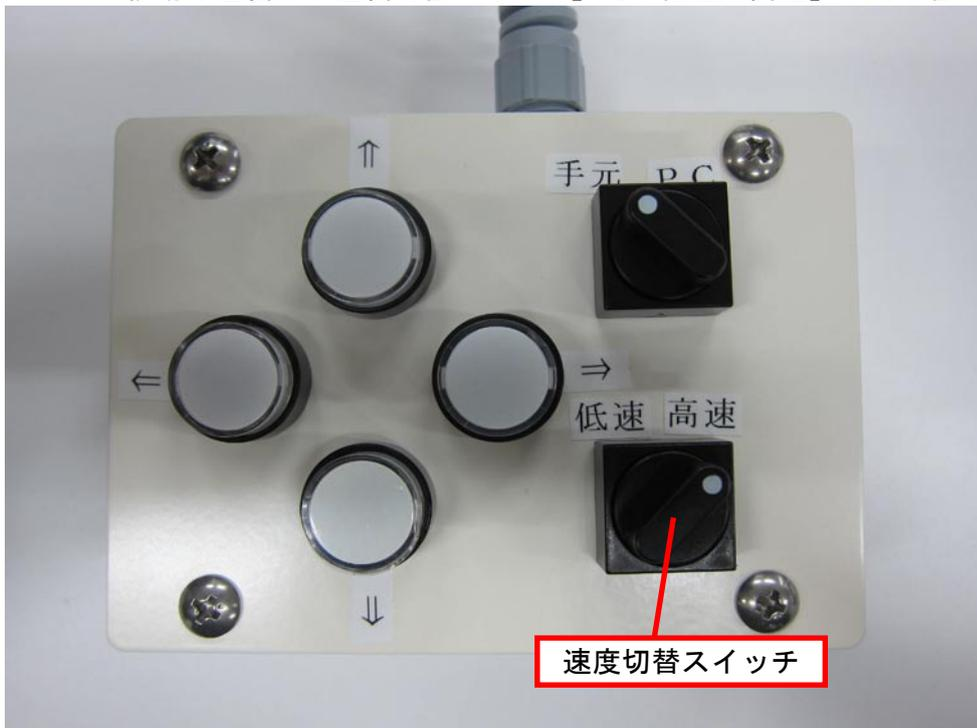
※視野の端までステージが移動し、それ以上の移動ができなくなると、ボタンが点滅します。
