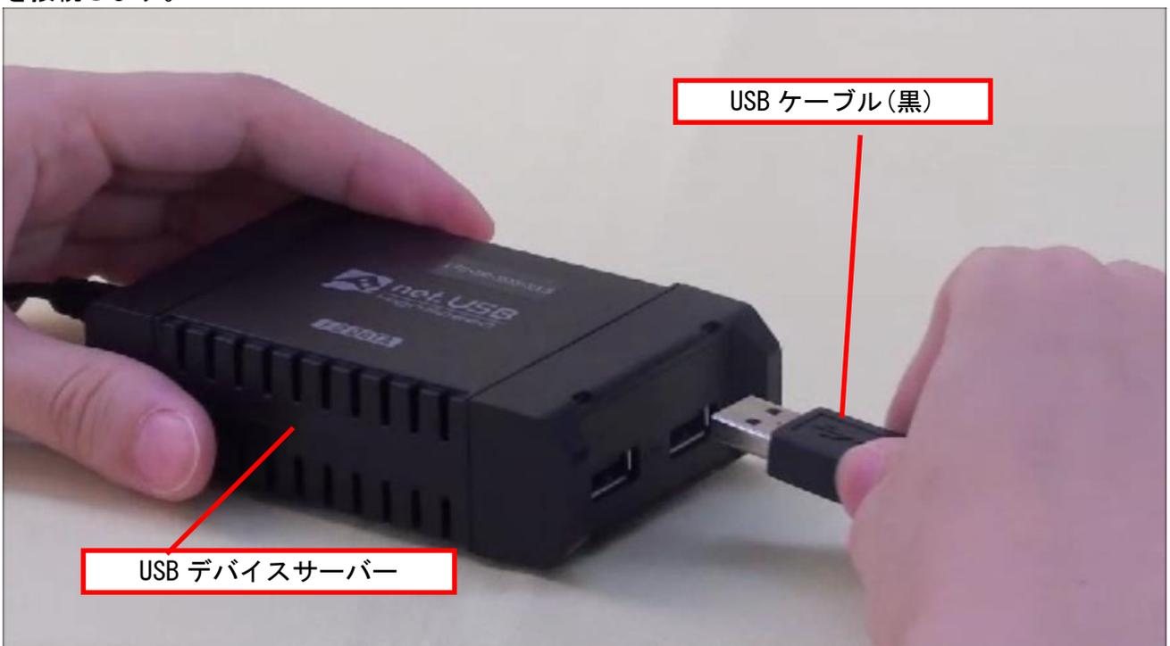
コントロールユニットの背面にケーブル(黒)と、USB デバイスサーバーから出ている USB ケーブル(黒)を接続します。
