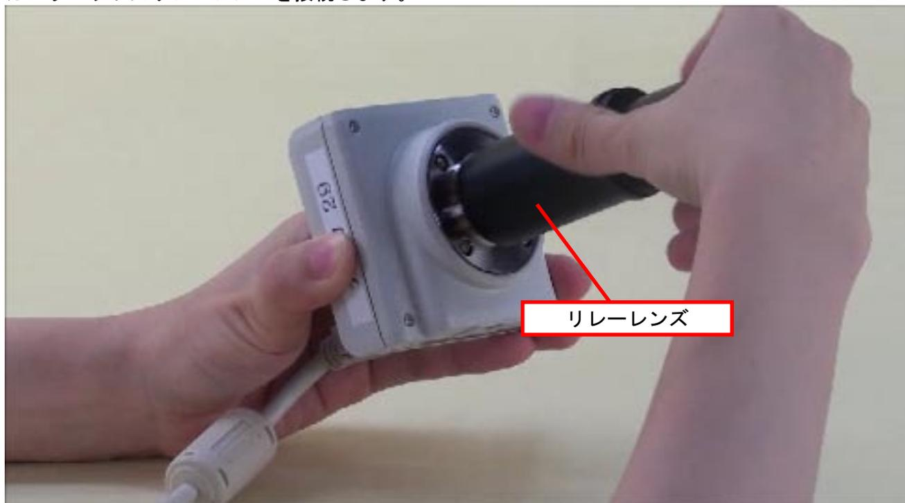
リレーレンズを鏡筒に差し込んで、カメラヘッドと生物顕微鏡を接続します。
