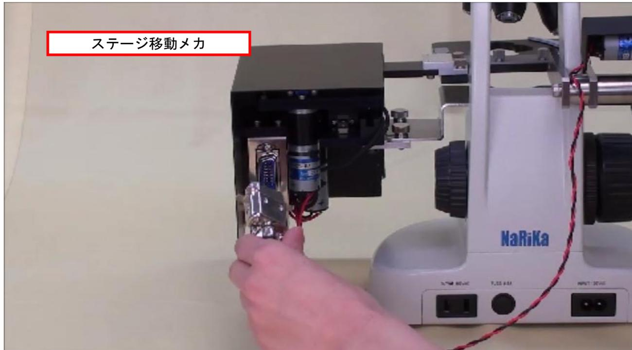
続いて、ステージ移動メカの背面に、焦点調節メカ背面から出ている丸ケーブルを接続します。
