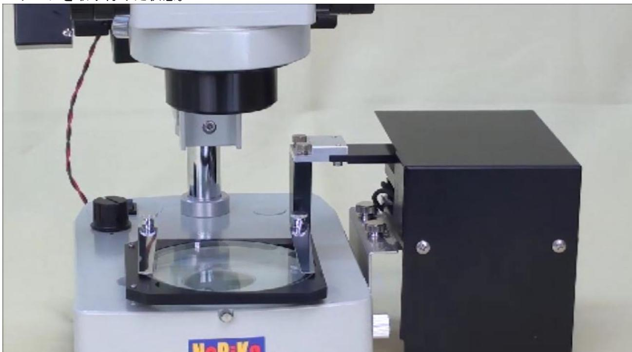
ステージ移動メカの背面にコントロールユニットから出ているケーブル(黒)の片方を接続します。
