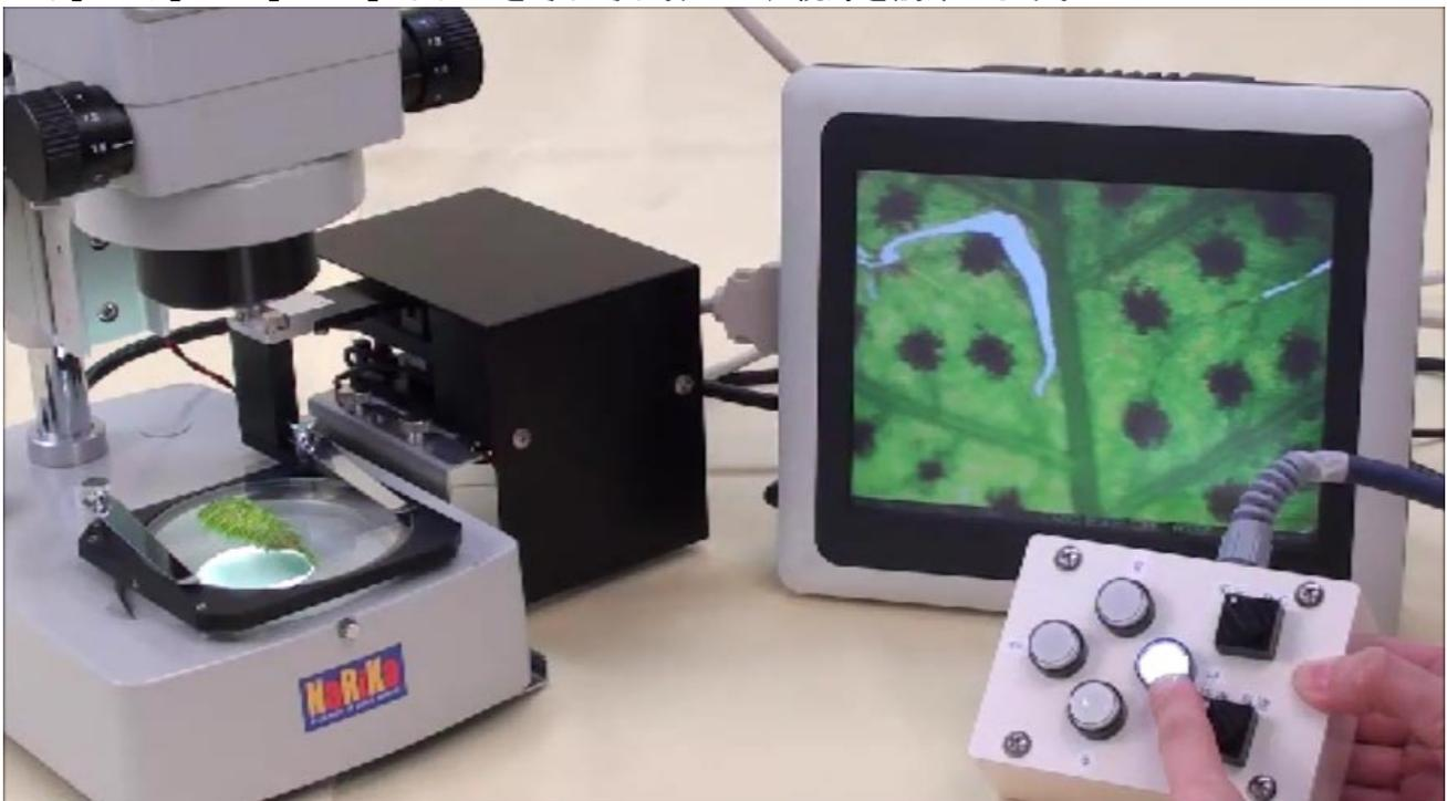
ステージ移動の速度は「速度切替スイッチ」で「低速／高速」の切り替えが可能です。
