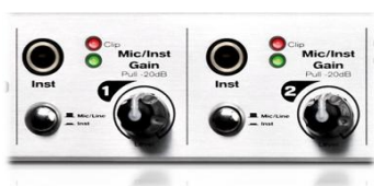
本校オーディオインターフェース (M-Audio Fast Track Ultra 8R) のマイクレベル(Gain)
