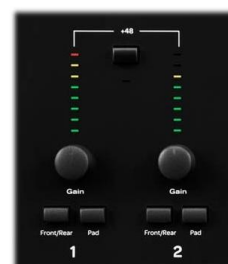
府立、京大オーディオインターフェース(M-Audio Fast Track C600)のマイクレベル(Gain)
